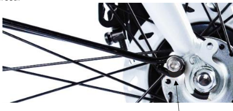
bevestiging spatbordstang
