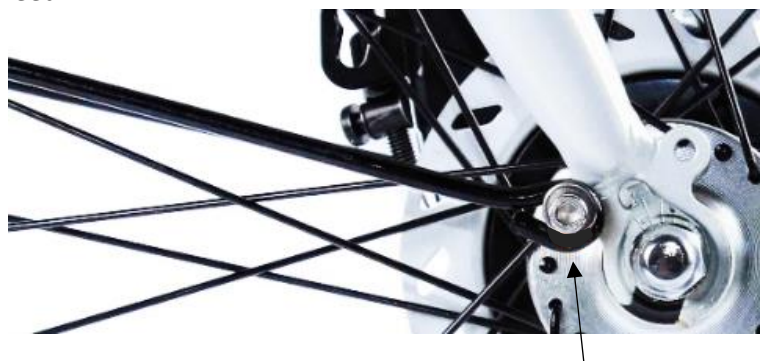
bevestiging spatbordstang
